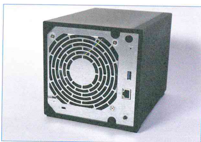
↑機器後方有著大大的風扇，電源開關則放在機器後方的右上角，有顆黑色的按鈕。
